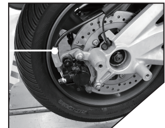
(233cm, 1彎1直) 彎頭在ABS電腦端 另一直頭連接 後卡鉗 233cm: straight-> rear caliper / bent-> ABS
