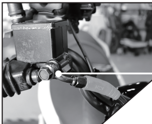
(45cm-1彎1直) 直頭在ABS電腦端 另一彎頭連接 右拉桿 45cm: bent-> right lever straight-> ABS
