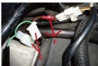
8.將線組F接頭插入電盤訊號接線夾(四期用)。 備註：線組E接頭為五期車輛，直接將電盤訊號插頭拔除，接上線組E公母頭即可(五期用。)
