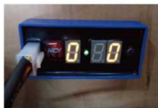
9.打開電門前檢查本體燈號是否有正常，正常後再將本體用魔鬼氈黏於置物箱上(本體調整方式，說明在包裝外盒上。)
