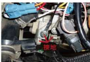
2.先將DCP接頭拔除，將接地鎖上節流閥。
