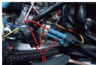
4.將空氣旁空閥插頭拔下，將線組B公母頭接上。
