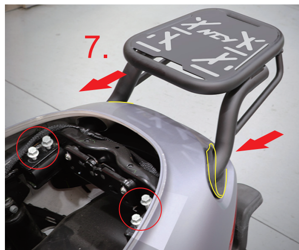
7. 塞好兩邊防塵套後，將NCY貨架平行推進，並鎖緊原廠4顆螺絲。
