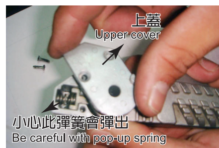
3.順著彈簧的力量將上蓋旋轉180度。 Follow spring strength to turn upper cover 180°
