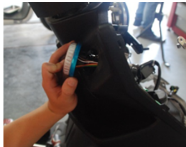
步驟7: 安裝鎖頭座及接上電線，負極與喇叭一起鎖附並套好防水套 (照片上無防水套請依實物為主)
