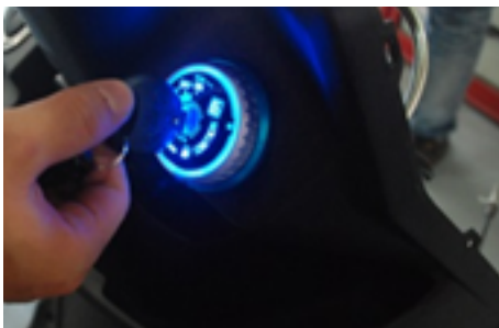
步驟7: 測試功能是否正常，測試完成後固定線組及防盜器本體 (請依照個人喜好固定)
