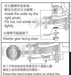
設定剎車鎖定功能時,按壓拉桿請保留一點間隙 方便拉桿有空間解鎖。
