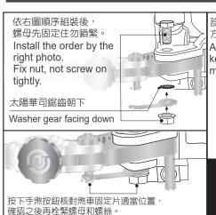
設定剎車鎖定功能時,按壓拉桿請保留一點間隙 方便拉桿有空間解鎖。
