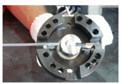
2. ADJUST CUTTING TOOL TO THE FIT LENGTH.
