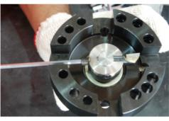
3. ADJUST CUTTING TOOL TO THE FIT LENGTH.
